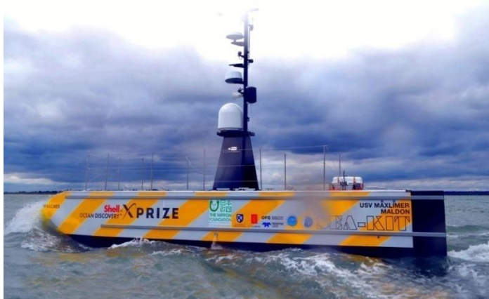
Εικόνα: Το πρώτο πειραματικό μη επανδρωμένο πλοίο «USV Maxlimer» όπου θα εκτελέσει υπερατλαντικό ταξίδι.
