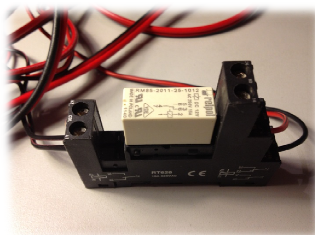
Εικόνα 27: Relay socket RT626
