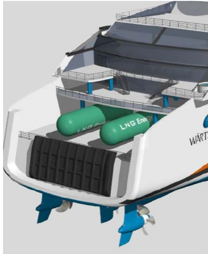
Σχήμα 4.17: Εξωτερική αποθήκευση φυσικού αερίου σε πλοίο [21]
