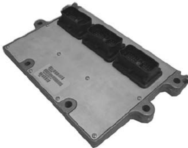
Σχήμα 4.10: Κύριο στοιχείο ελέγχου σε σύστημα ελέγχου μηχανής διπλού καυσίμου[20]
