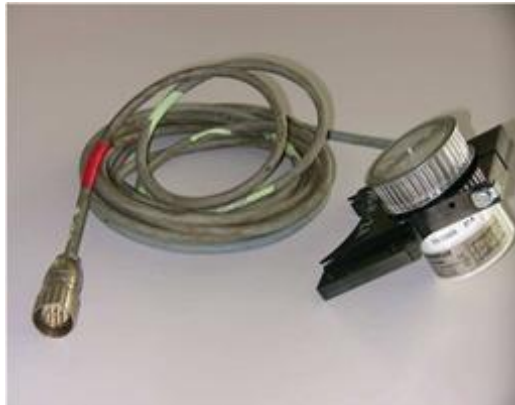
Εικόνα 7: Ο αισθητήρας γωνίας στροφάλου με το στήριγμά του και το καλώδιο μετάδοσης ψηφιακού σήματος (CAS).
