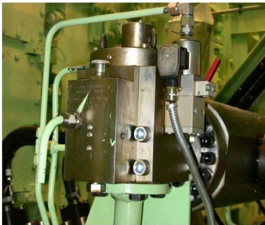
Εικόνα 16: Ηλεκτρομαγνητική βαλβίδα και χειροκίνητος μοχλός, για πτώση της πίεσης πετρελαίου στον CR.
