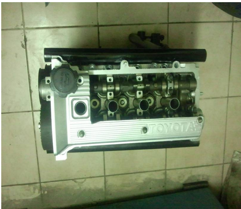
Εικόνα 5.2 Τομή στην κεφαλή της μηχανής
