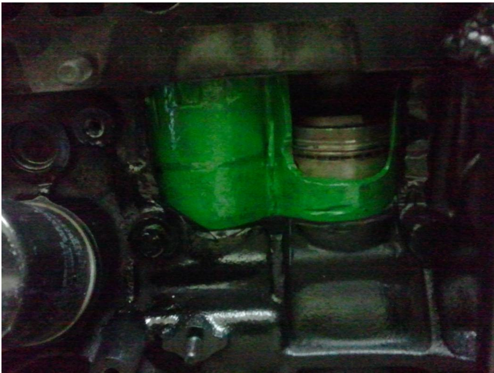
Εικόνα 5.1 Τομή στο υδροχιτόνιο
