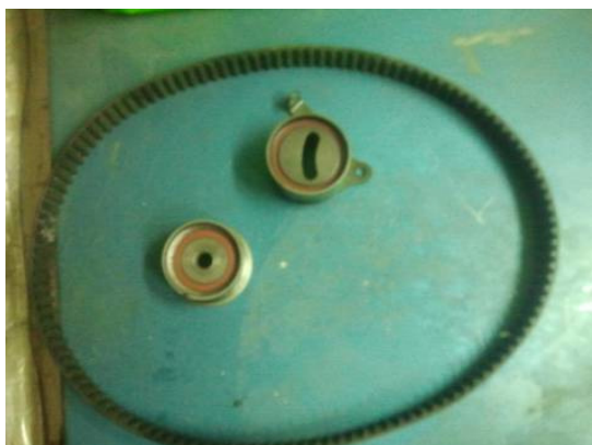
Εικόνα 6.13.1 Ιμάντας χρονισμού με τα ρουλεμάν του σωστή λειτουργία του κινητήρα.
