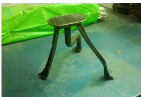
Εικόνα 6.12.1 Αναρρόφηση αντλίας απο ελαιολεκάνη .
