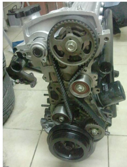
Εικόνα 5.3 Τροχαλίες και μιάντας χρονισμού
