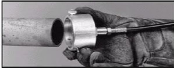
Εικόνα 88: Διάταξη προστασίας της ρίζας στη συγκόλληση TIG σωλήνα
