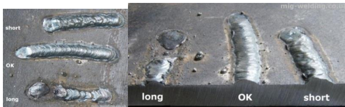
Εικόνα 73: Επίδραση του μήκους του τόξου στη μορφή της συγκόλλησης
