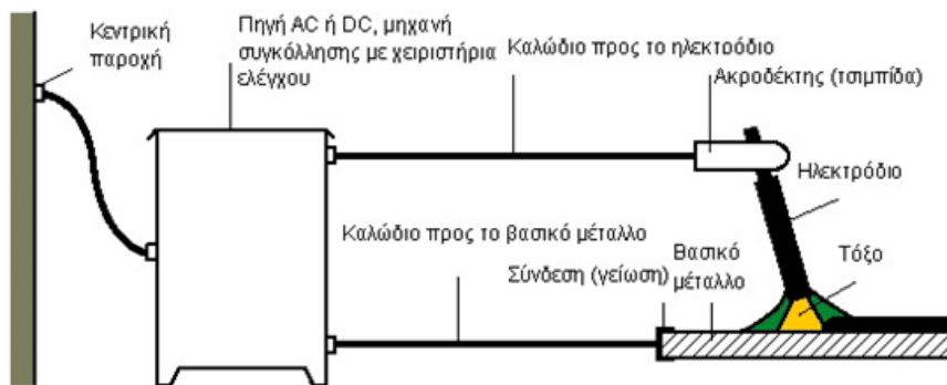
Εικόνα 31: Το βασικό κύκλωμα ηλεκτροσυγκόλλησης τόξου
