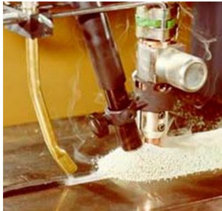
Εικόνα 91: Εφαρμογή μεθόδου συγκόλλησης βυθισμένου τόξου
