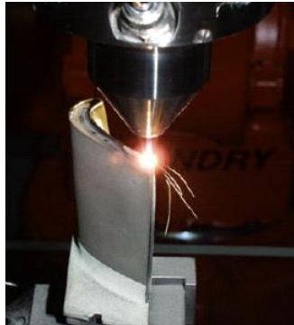
Εικόνα 114: Αναγόμευση με συγκόλληση laser σε πτερύγιο αεροκινητήρα
