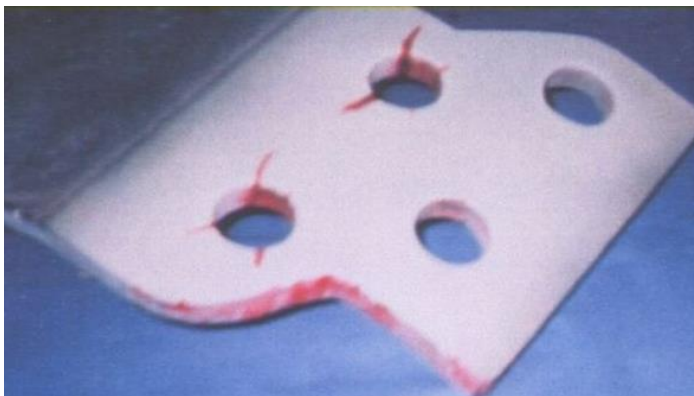
Εικόνα 129: Έλεγχος για ρωγμές με τη βοήθεια διεισδυτικών υγρών
