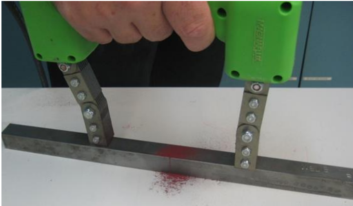
Εικόνα 130: Έλεγχος για ρωγμές με τη βοήθεια μαγνήτη ή ηλεκτρομαγνήτη
