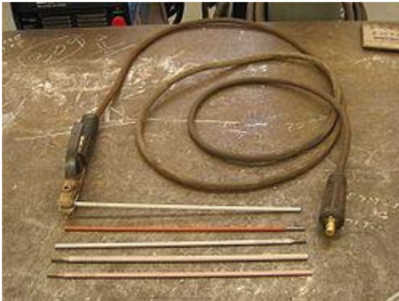
Εικόνα 41: Επενδεδυμένα ηλεκτρόδια: Τιμπίδα, Ηλεκτρόδια και καλώδιο συγκόλλησης
