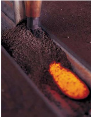
Εικόνα 92: Εφαρμογή μεθόδου συγκόλλησης βυθισμένου τόξου
