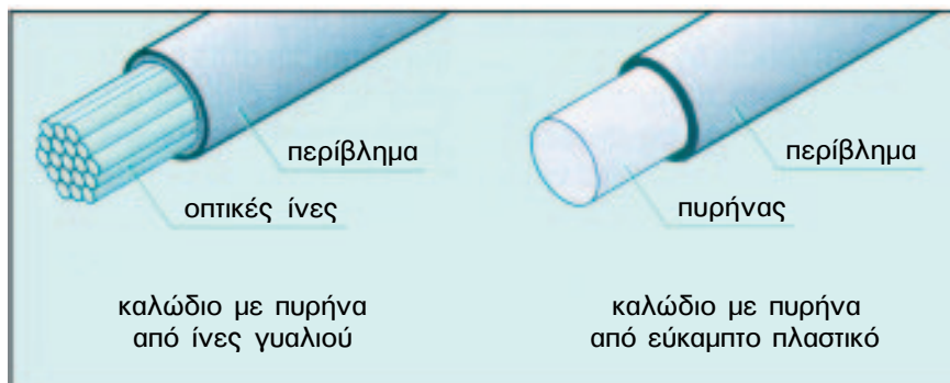
Σχήμα 5.38: Δομή καλωδίων οπτικών ινών.
