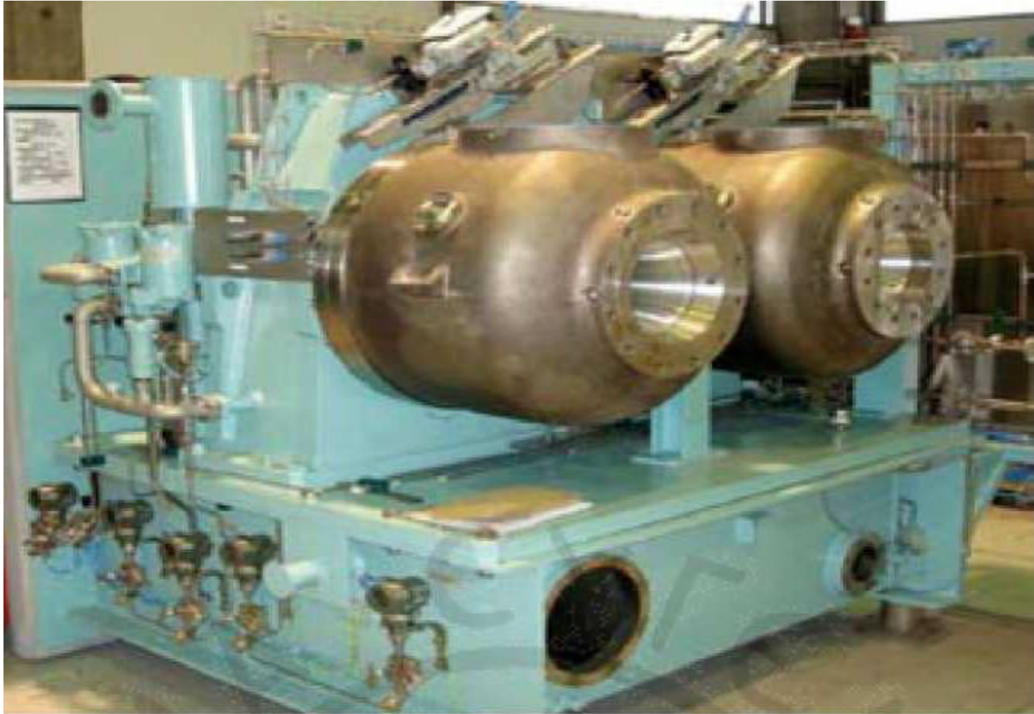
Φυγοκεντρικός συμπιεστής φυσικού αερίου LNG.
