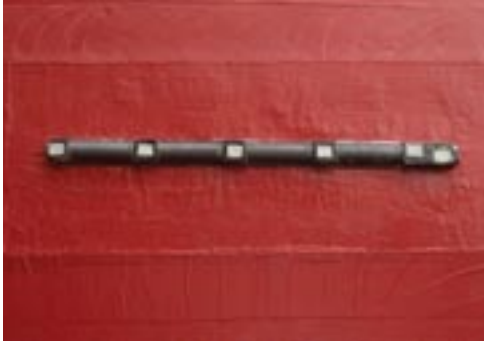
Σχ. Π.Β.12β Γραμμικό ανόδιο τοποθετημένο στη γάστρα του πλοίου.
