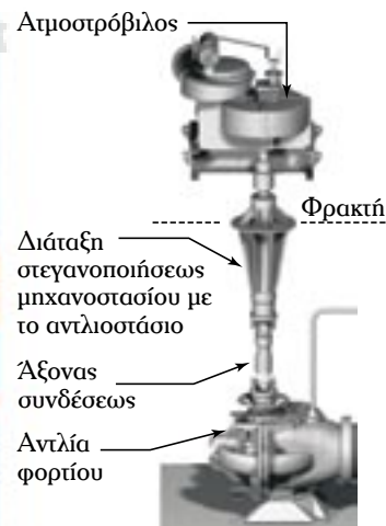
Κάθετη αντλία φορτίου με στροφέιο (περωτή) διπλής αναρρόφησης. (α) Τομή της αντλίας. (β) Τομή της αντλίας όπου διακρίνεται το στροφέιο και (γ) διάταξη αντλιών σε αντλιοστάσιο Δ/Ξ.
