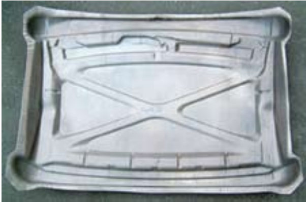
Εσωτερική ενίσχυση οροφής αυτοκινήτου
